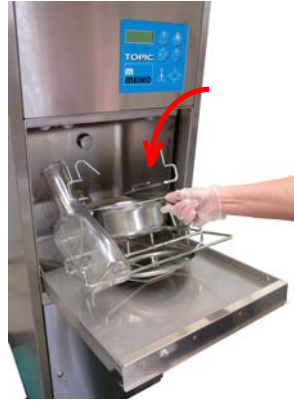
2. Mettere gli utensili da lavare nella posizione prevista nel supporto per recipienti.
