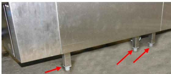
Zur Verstellung der Maschinenfüße ist ein Schraubenschlüssel der Schlüsselweite SW 27 notwendig!
