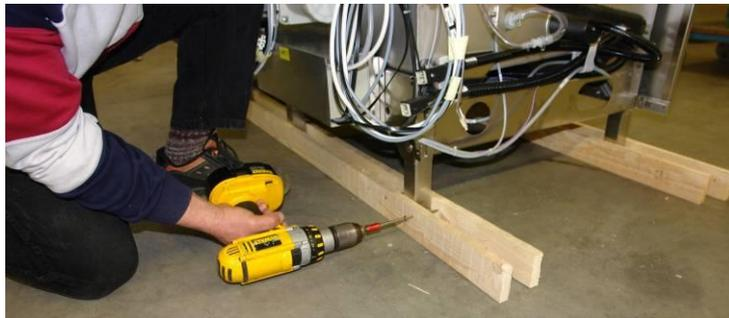
Anschließend werden alle Befestigungsschrauben und alle Holzteile entfernt.
