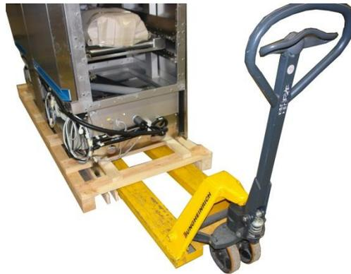
Die Maschinen sind grundsätzlich mit dem Verpackungsholz zu transportieren. Die Verpackung ist so konstruiert, dass ein sicherer und gefahrloser Transport mit einem Hubwagen möglich ist.
