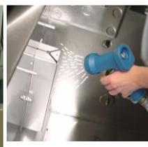
Schwimmergehäuse der Wasserstandsüberwachung abspritzen.
