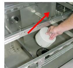
Entfernen Sie das Pumpenansaugsieb.
