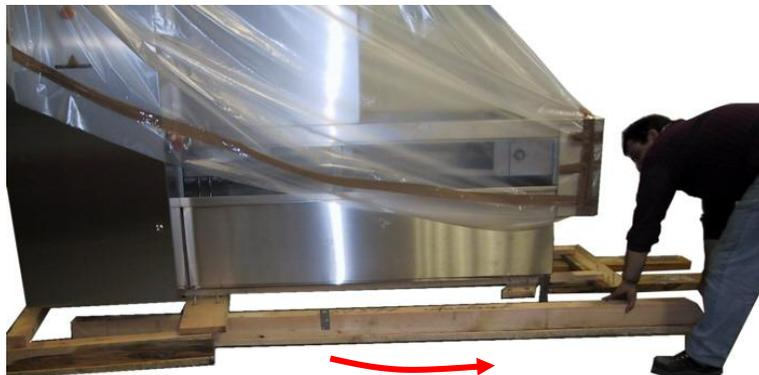
Nun wird die Maschine wieder auf den Boden abgelassen. Die Hubwagen werden entfernt. **Bitte beachten Sie dass die Maschine nicht ruckartig abgesetzt wird**, die Maschinenstollen könnten zerstört werden. Weiter beachten Sie bitte, dass die Maschinenstollen gleichmäßig ausgedreht sind um ein einseitiges Belasten der Maschinenstollen zu vermeiden. Eine gleichmäßige Belastung kann man beim Drehen am Gabelschlüssel durch die eingesetzte Kraft erfühlen.
