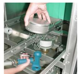
Reinigen Sie das Pumpensieb.
