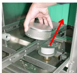
Entfernen Sie das Pumpenansaugsieb
