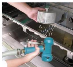
Reinigen Sie das Pumpensieb.
