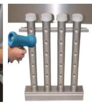
Reinigen Sie die Waschrohre- + Pumpenklarspülarme und deren Düsen. Zum Reinigen der Düsen, benutzen Sie eine Nylon Bürste. Überprüfen Sie die Wascharme und Endkappen auf Vollständigkeit und Dichtheit.
