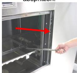
Entfernen Sie die Pumpenklarspülarme.
