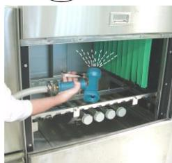
Innenraum der Maschine und Rückseite der Hubtür mit einem Wasserschlauch abspritzen.
