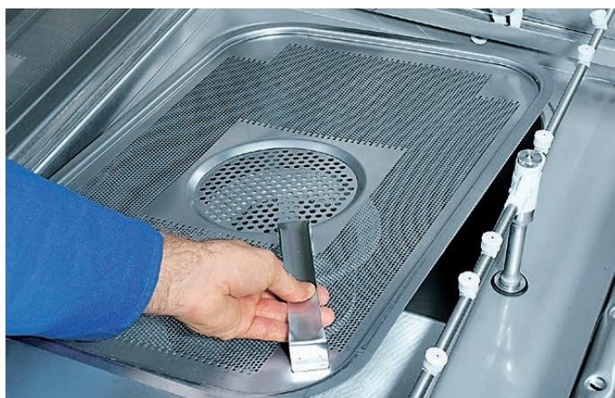
**Tamiz de cubierta del tanque**
