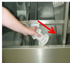
Nachdem Sie die Maschine gereinigt haben, bauen Sie alle Teile wieder ein, und prüfen Sie diese auf Vollständigkeit und richtige Position.
