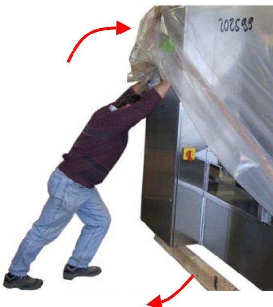
Beim Endgültigen Aufstellen der Maschine darauf achten, dass alle Maschinenstollen ungefähr das gleiche Gewicht tragen.
