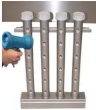
Reinigen Sie die Wasch- + Klarspülarme und deren Düsen. Zum Reinigen der Düsen, benutzen Sie eine Nylon Bürste. Überprüfen Sie die Wascharme und Endkappen auf Vollständigkeit und Dichtheit.
