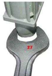
Zur Verstellung der Maschinenstollen ist ein Schraubenschlüssel der Schlüsselweite SW 27 notwendig!
