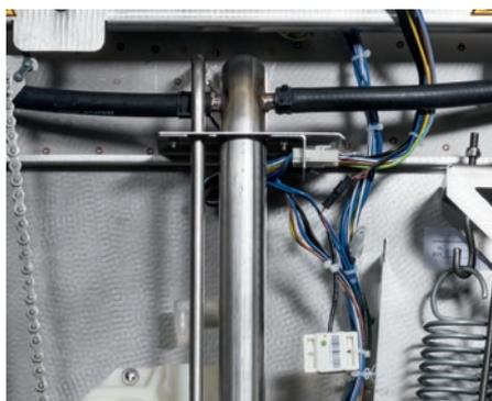
Colonne montanti in acciaio inox.
