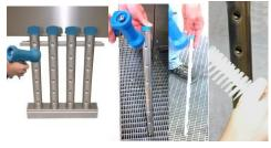
Reinigen Sie alle Spülarme und Düsen. Zum Reinigen der Düsen, benutzen Sie eine Nylon Bürste. Überprüfen Sie die Wascharme + Endkappen auf Vollständigkeit +Dichtheit.
