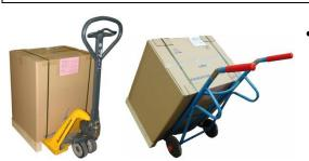
Die Spülmaschine ist grundsätzlich mit dem Verpackungsholz zu transportieren. Die Verpackung ist so konstruiert, dass ein sicherer und gefahrloser Transport mit einem Hubwagen oder Stechkarren möglich ist.
