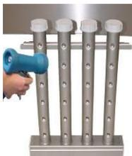
Reinigen Sie die Waschrohre- + Pumpenklarspülarne und deren Düsen. Zum Reinigen der Düsen, benutzen Sie eine Nylon Bürste. Überprüfen Sie die Wascharme und Endkappen auf Vollständigkeit und Dichtheit.
