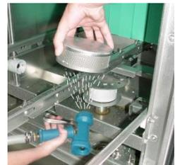
Reinigen Sie das Pumpensieb.
