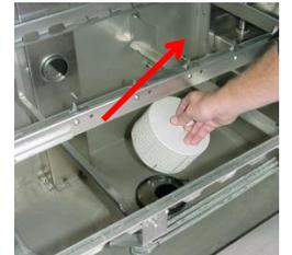
Entfernen Sie das Pumpenansaugsieb.
