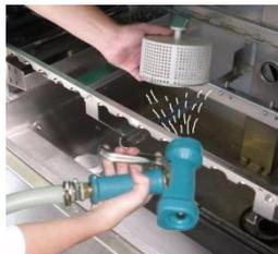
Reinigen Sie das Pumpensieb.
