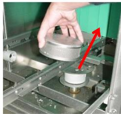
Entfernen Sie das Pumpenansaugsieb
