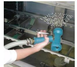
Reinigen Sie den kompletten Tankinnenraum mit einem Wasserschlauch
