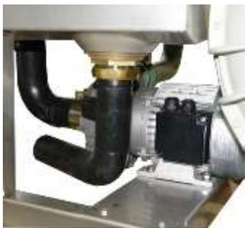
Tutti gli scarichi d'acqua della macchina si devono collegare alla rete di scarico del locale, attraverso un dispositivo contro malodori di sufficiente grandezza.
