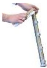
Pulire tutte le sfere di lavaggio + sfere di risciacquo e gli ugelli. Per la pulizia degli ugelli, usare una spazzola di nylon. Verificare la completezza ed ermeticità delle sfere di lavaggio e cappucci.
